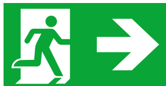
Bild 1: Rettungszeichen gemäß DIN ISO 7010 mit Richtungspfeil rechts. Die Pfeilrichtung kann je nach Fluchtrichtung unterschiedlich sein.
