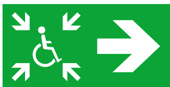
Bild 6: Rettungszeichen gemäß DIN ISO 7010 mit Richtungspfeil rechts; die Pfeilrichtung kann je nach Fluchtrichtung unterschiedlich sein.
