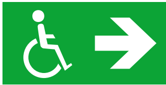
Bild 4: Barrierefreier Rettungsweg und Richtungspfeil; die Pfeilrichtung kann je nach Fluchtrichtung unterschiedlich sein.
