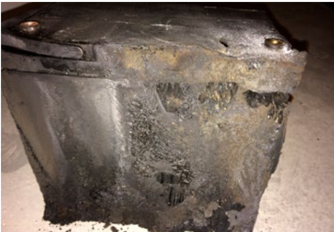
Bild 8: Nicht rechtzeitig erkannter Frühausfall einer Batterie
