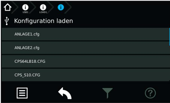
Sofern sich mehrere Konfigurationsdateien in diesem Ordner befinden, ist die entsprechende auszuwählen. Mittels betätigen der jeweiligen Schaltfläche wird die Konfiguration geladen.
