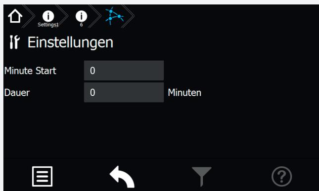
Über die Schaltfläche „Minute Start“ wird die Startzeit in Minuten eingestellt. Mittels der Schaltfläche „Dauer“ wird die die Lüftereinschaltdauer bestimmt.
