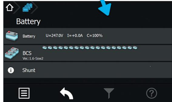
Im unteren rechten Eckbereich befindet sich eine Schaltfläche, mit der Einstellungen des Menüs „Shunt“ durchgeführt werden können.
