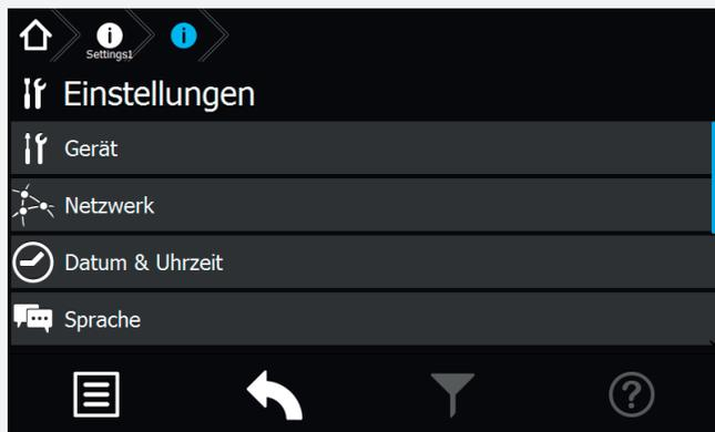
Im Bereich „Einstellungen“ können Programmierungen der Gerätekonfigurationen durchgeführt werden. Einstellungen der Netzwerkanbindung, automatische Testeinstellungen, Einstellungen der Lüftersteuerung sowie der Uhrzeit und des Datums sind in diesem Menü möglich. Weiterhin kann im Bereich „Learn-Mode“ die gewünschte Überwachungsart angelernt werden, die individuelle Vergabe eines Passwortes ist im Bereich „Passwort“ möglich.
