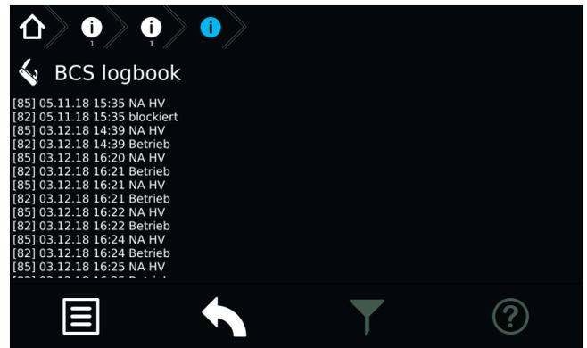
Die dargestellten Werte aller angemeldeten BCS Sensoren werden im BCS Prüfbuch mit den aktuellen Daten (zuletzt erfolgte Prüfung) von oben nach unten aufgeführt.
