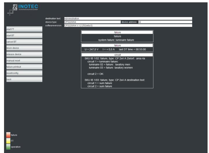
Der Störungsausdruck zeigt alle Störungen des Gerätes auf einer Seite im Klartext an. Für ein Ausdruck wird die Druckfunktion des Webbrowsers genutzt, welche über Datei → Drucken aufgerufen wird.
