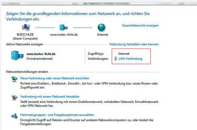
Durch betätigen der Schaltfläche „LAN-Verbindung“ öffnet sich die Statusanzeige dieser Verbindung. Nach Betätigen des Buttons „Eigenschaften“ werden Sie in das Menü „Eigenschaften der LAN-Verbindung“ geführt.
