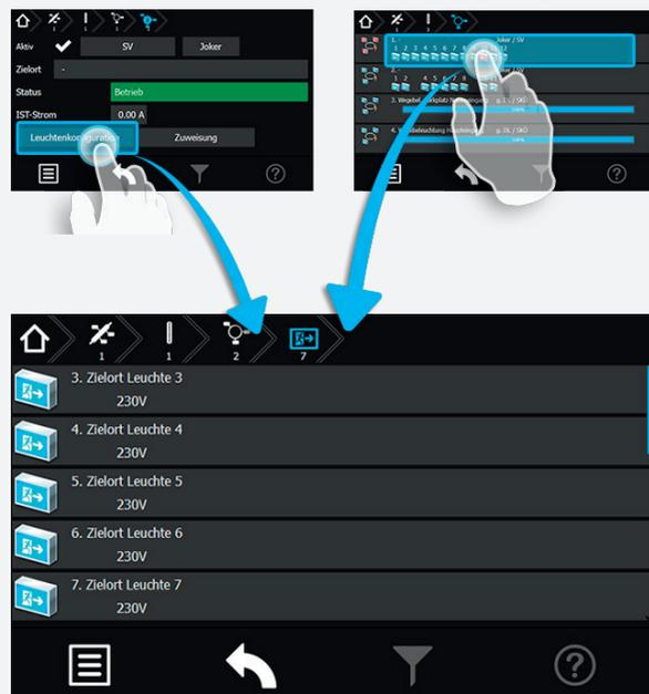
Eine weitere Möglichkeit in das Untermenü „Leuchten“ zu gelangen ist, die Betätigung der Schaltfläche „Angemeldete Leuchten“ im Menü „Endstromkreise“.
