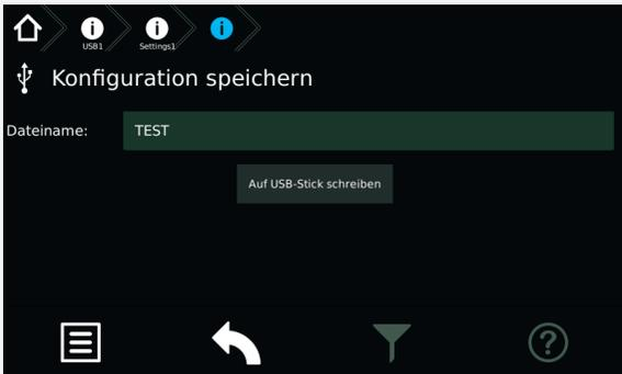
Das Feld für die Dateibezeichnung ist zunächst leer. Um eine Konfigurationsdatei zu speichern ist die manuelle Vergabe eines Dateinamens erforderlich. Durch betätigen der Beschriftungszeile gelangen Sie in ein Untermenü, indem mittels einer Tastaturanordnung der Dateiname vergeben werden kann.
