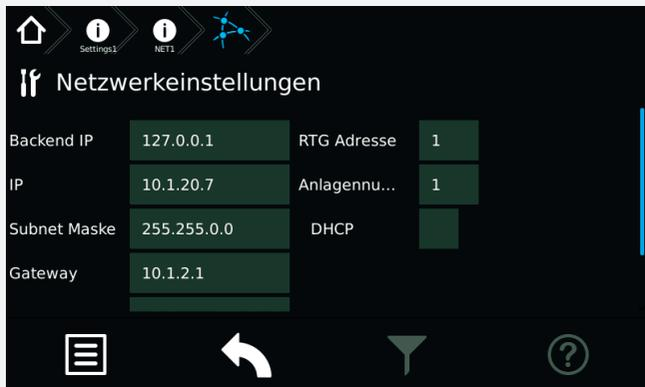
Die IP Adresse kann mittels der IP Schaltfläche angepasst werden.
