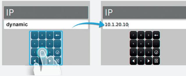
Nach manueller Eingabe der IP Adresse ist dieses Menü durch Betätigen des Button zu verlassen.
