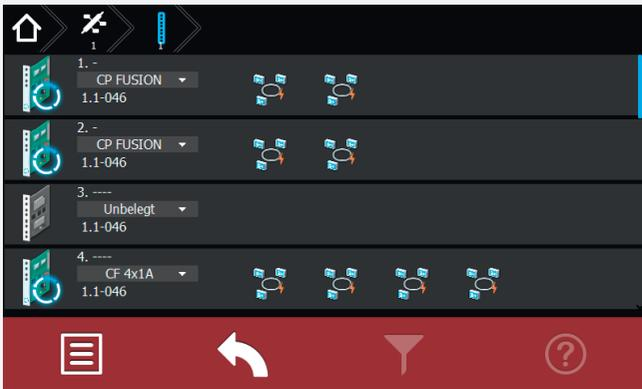
Im Programmiermodus ist es möglich über das Dropdown Menü einen Einschub an oder abzumelden. Alle Einschübe die mit der Anlage kompatibel sind stehen im Dropdown Menü zur Verfügung. Durch Klicken auf den gewünschten Einschub wird dieser ausgewählt und gespeichert.
