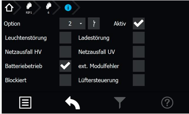
In diesem Dialog kann die Schaltungsart (Schließer oder Öffner) des gewählten Kontaktes bestimmt werden. Weiterhin ist hier die Zuweisung der Meldungsarten möglich.
