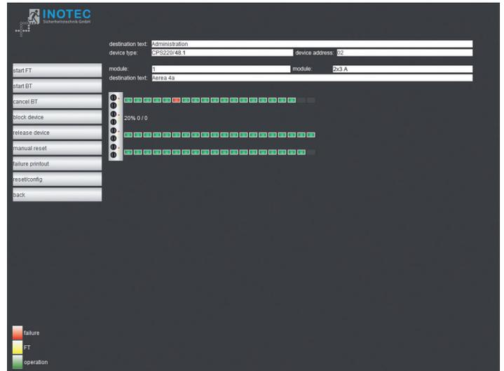
Die Zielorte werden in der Stromkreisdarstellung angezeigt, die mit einem Mausklick auf die Leuchten aufgerufen wird.
