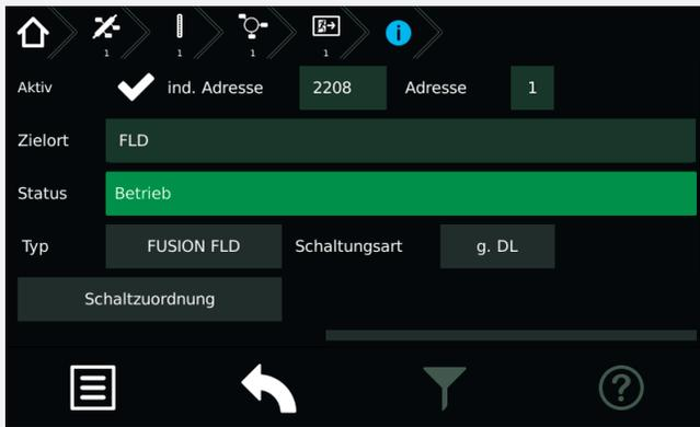
Bei 24V Leuchten ist die individuelle sowie die frei programmierbare Adresse der Leuchte den beiden oberen Sichtfenstern zu entnehmen. Betriebsstatus, Leuchtentyp und zugewiesener Zielort können aus entsprechenden Datenfeldern entnommen werden. Die Schaltungsart und der Stromwert werden in den unteren Informationsfeldern dargestellt.
