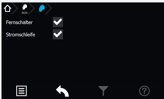
In diesem Untermenü werden folgende Detailinformationen zum SLÜ-Modul (separates Modul oder integriert im RIF5-Modul) angezeigt. Diese beiden Checkboxes zeigen die Aktivierung oder Deaktivierung der jeweiligen Überwachung an.
