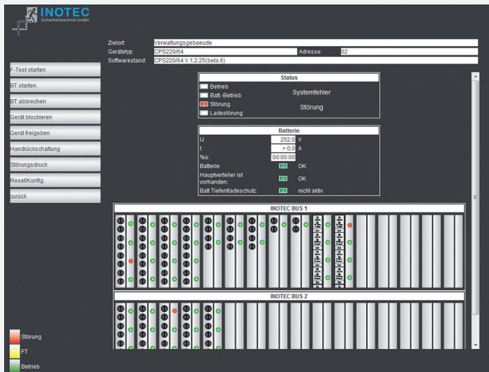
Über die INOWeb-Schnittstelle können die Statusinformationen zur Leuchte mittels eines Webbrowsers dargestellt werden. Dazu wird die CPS FUSION in ein lokales Netzwerk eingebunden.
