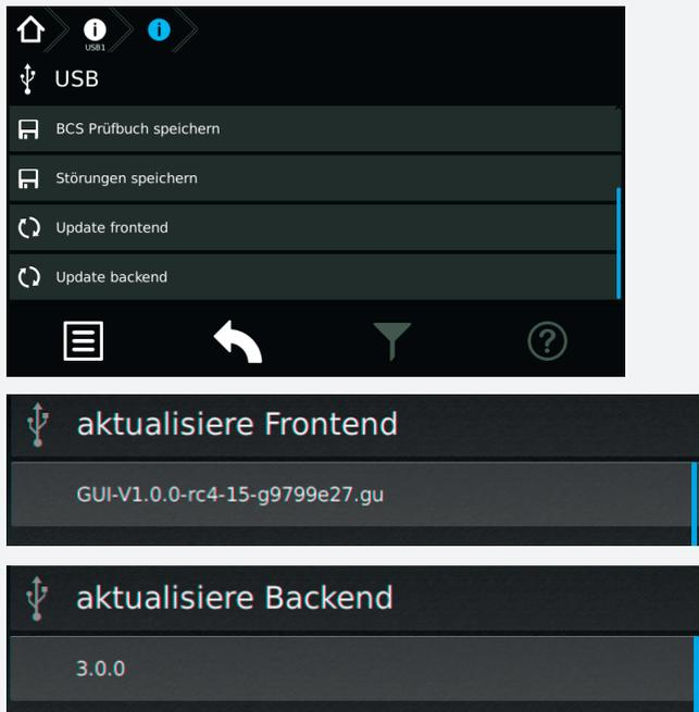
Durch Auswahl dieser Datei werden die Daten geladen und das Steuerteil bootet mit der neuen Software.
