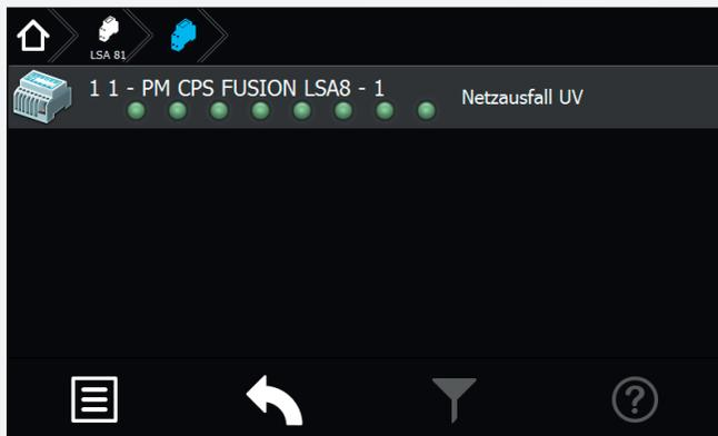
Mit den LSA8- und LSA 3.1-Modulen ist ein gemeinsames Ein- und Ausschalten von Netz- und Sicherheitsleuchten möglich. Den Endstromkreisen können in der Programmierung bis zu drei Schalteingänge zugewiesen werden.
