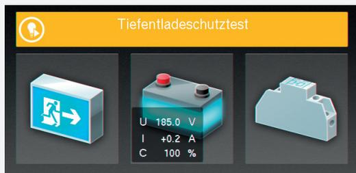
Nach Beendigung des Testvorganges bleibt die untere Spannungsgrenze für kurze Zeit sichtbar. Die Batterie wechselt, sofern die Abschaltung in Ordnung war, wieder zurück in den grünen Farbmodus.
