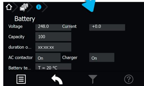
Hier werden Informationen der „Spannung“, dem „Strom“, der „Kapazität“, der „Dauer des letzten Betriebsdauertest“ und der „Batterietemperatur“ dargestellt. Weiterhin werden Status des „AC/DC-Schütz“ und „Ladeteil“ aufgeführt. In diesem Bereich werden lediglich Daten angezeigt, es können keine Einstellungen vorgenommen werden.
