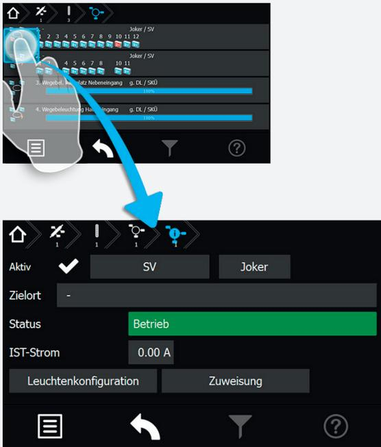
Das Untermenü des jeweiligen Endstromkreises beinhaltet Statusinformationen. Die Art der Überwachung und Schaltung sind in den beiden oberen Comboboxen einzustellen. Weiterhin sind Zielort, Status und „Ist“ Stromaufnahme des Endstromkreises zu erkennen.
