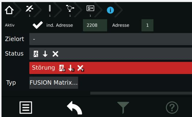
Für dynamische Leuchten wird im Statusfeld die aktuelle Anzeige der Leuchtenmatrix grafisch angezeigt. Dieses in Abhängigkeit von den aktiven Schalteingängen und der Programmierung.
