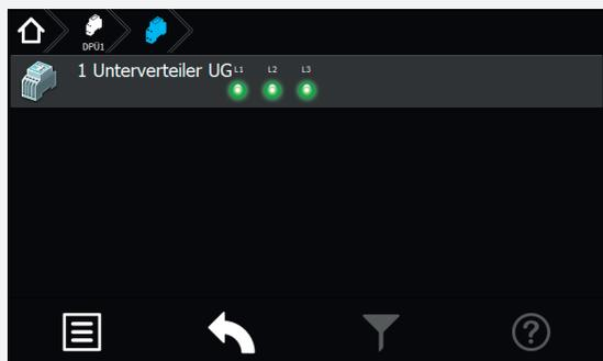
Zur Überwachung der Netzspannung an den Unterverteilern der Allgemeinbeleuchtung werden die DPÜ/B-Module direkt in den Unterverteiler eingebaut. Die Abfrage der Module erfolgt über den Bus IB2 oder IB3. Es können bis zu 31 busfähige Dreiphasenüberwachungen angeschlossen werden. Bei Ausfall einer Phase wird diese im Steuerteil angezeigt.
