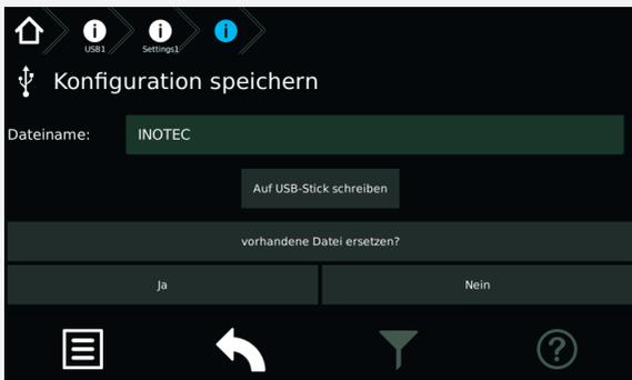
Eine Bestätigung mit „Nein“ führt zum Abbruch des Speicherprozesses. Durch Auswahl der Schaltfläche „Ja“ erhalten Sie eine Bestätigung der erfolgreichen Speicherung.
