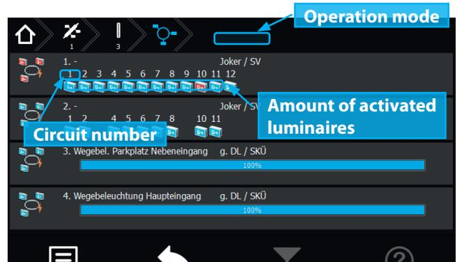
Die einzelnen Endstromkreise sind in separate Schaltflächen unterteilt. In den jeweiligen Schaltflächen wird die Anzahl der angemeldeten Leuchten, die Stromkreisnummer sowie die Schaltungsart dargestellt.
