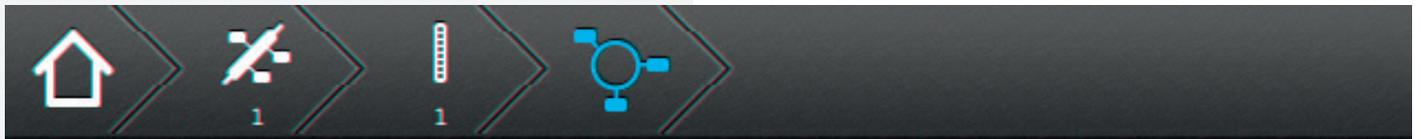
Die Breadcrumb-Navigation befindet sich oberhalb der Bedienoberfläche. Für jedes aktivierte Untermenü wird in der Breadcrumb-Navigation ein entsprechendes Symbol gesetzt. Sofern ein weiteres Menü aufgerufen wird, verlängert sich die Leiste um ein zusätzliches Symbol, welches den aktuellen Menüpunkt in Blau darstellt.
