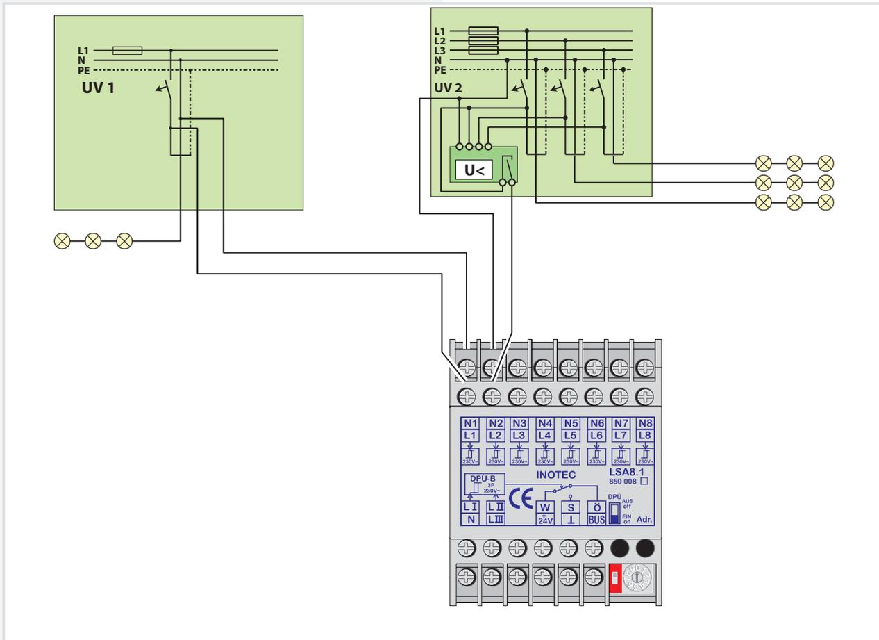
Für eine Meldung des Netzausfalls UV bei Unterbrechung der Schleife am Eingangskanal ist dieses in der Steuerteilprogrammierung einzustellen.
