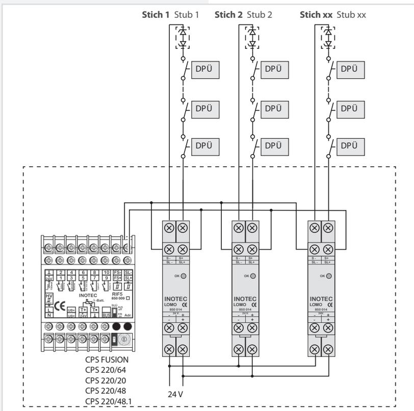
Das Loop-Monitoring-Modul muss in das Sicherheitslichtgerät eingebaut werden!
