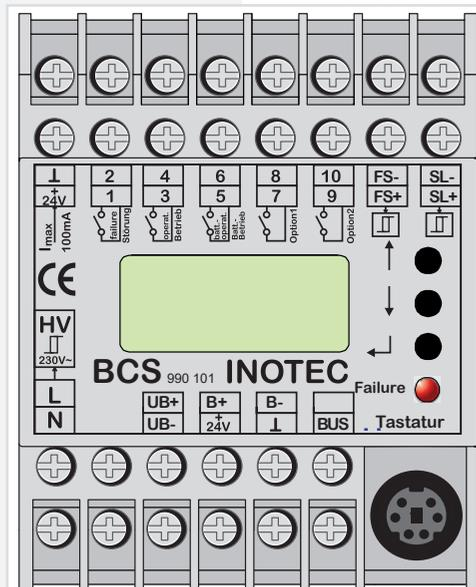
welche an die Klemmen B+ und B- angeschlossen werden. Die einzelnen Sensoren registrieren Spannung und Temperatur von jedem Batterieblock.
