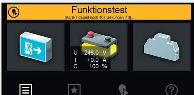
Im Funktionstestmodus schaltet das Gerät in den Batteriebetrieb und überprüft die angeschlossenen und angemeldeten Leuchten auf deren Funktionstüchtigkeit. Das Ergebnis des Funktionstest wird im Prüfbuch abgespeichert. Der aktuelle Status wird in der „Statusanzeige“
