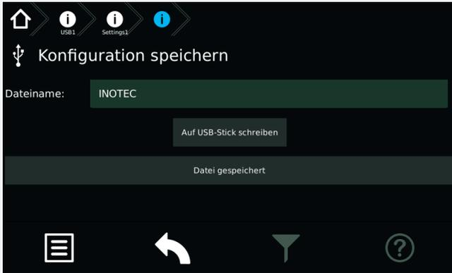
Sofern sich eine Datei mit identischer Bezeichnung auf dem Speichermedium befindet, erhalten Sie vor der Speicherung die Sicherheitsabfrage „vorhandene Datei ersetzen?“. Diese ist entsprechend mit „Ja“ oder „Nein“ zu beantworten.
