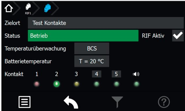
In den oberen Anzeigefeldern wird der vergebene Zielort sowie der aktuelle Gerätestatus angezeigt. Für eine temperaturgeführte Ladung kann mittels Combobox zwischen folgenden Bereichen ausgewählt werden:
