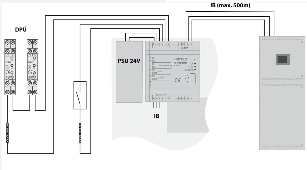
Bei einem lokalen Netzausfall am IB-Repeater Modul schalten nur die nachgeschalteten BUS-Unterstationen in den Netzausfall UV-Betrieb. Bei einem Netzausfall UV am Hauptgerät werden alle Stromkreise, auch die der CPUSB eingeschaltet.
