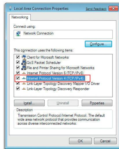
Die Schaltfläche „Eigenschaften“ ist dadurch aktiv und führt durch betätigen in das Untermenü des Elementes „Internetprotokoll Version 4 (TCP/IPv4)“, indem die IP Adresse und Subnetzmaske konfiguriert werden können. Die Schaltfläche „Deinstallieren“ wird in diesem Schritt „ausgegraut“.
