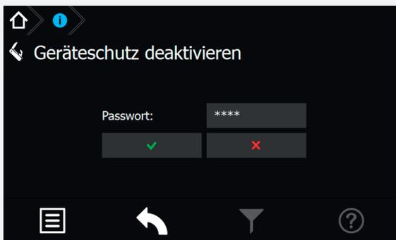
Nach Eingabe des richtigen Passwortes wird der Zugriff auf das Steuerteil freigegeben.
