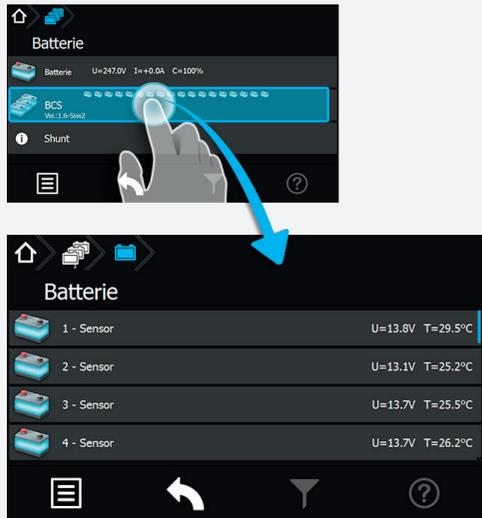
Jeder Sensor ist in einer separaten Tabellenspalte mit aktuellen Werten des zu überwachenden Batterieblocks dargestellt. Hier sind Daten zur Blockspannung und Temperatur der einzelnen Batterieblöcke aufgeführt. Die Tabellenspalten einzelner Sensoren sind nicht weiter zu öffnen.
