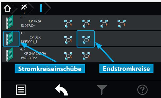
Sie befinden sich jetzt in der Ebene der Stromkreiseinschübe. Die Einschübe sind in der linken Menüseite senkrecht angeordnet. Die jeweilige Steckplatznummer sowie Art des Einschubes sind rechts neben dem Symbol des Stromkreiseinschubes zu erkennen. Die Stromkreise befinden sich den Einschüben untergeordnet, in waagerechter Anordnung, im rechten Menübereich.
