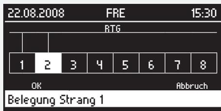
An einem Strang können max. 8 CLS Geräte angeschlossen werden. Durch Blinken wird die angewählte Adresse angezeigt. Die Auswahl der Adresse ändern Sie durch Drehen des Bedienknopfs. Wird der Bedienknopf gedrückt wird eine Adresse an- bzw. abgemeldet. Angemeldete Adressen sind hinterleuchtet und haben eine Verbindung zur waagerechten Linie am oberen Bildrand. Mit „OK“ bestätigen Sie die Änderungen und mit „Abbrechen“ verlassen Sie das Menü ohne die Änderungen zu übernehmen.
