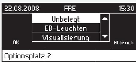
Um eine zweite Strangkarte für weitere 64 Einzelbatterieleuchten anzumelden, ist „EB-Leuchten“ anzuwählen und durch Drücken des Bedientropfes auszuwählen. Die Speicherung erfolgt durch Betätigen von „OK“. Mit „Abbruch“ kann das Menü ohne zu speichern verlassen werden.
