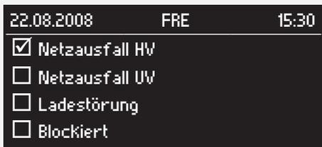
Durch Drehen des Bedienknopfs können die verschiedenen Zustände, bei denen der Kontakt geschlossen werden soll, angewählt werden. Die Zustände sind hierbei „oder“ verknüpft. Die Auswahl erfolgt durch Drücken des Bedienknopfs. Die ausgewählten Zustände werden nun durch einen Haken markiert.
