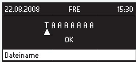
Der Name der Datei besteht aus 8 Buchstaben oder Ziffern. Durch Drehen des Bedienknopfes wird der gewünschte Buchstabe oder die Ziffer ausgewählt. Durch Drücken wird die Eingabe bestätigt und der Cursor wandert zur nächsten Stelle. Nach der Eingabe muss der Name mit einem erneuten Knopfdruck bestätigt werden.
