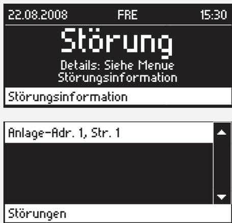
Falls mehrere Störungen aufgetreten sind, können diese durch Drehen des Bedienknopfs ausgewählt werden.
