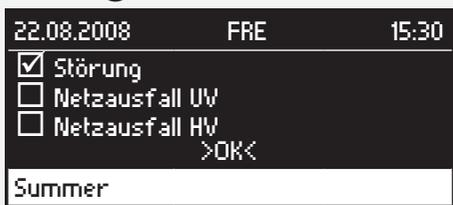
Durch Drehen des Bedienknopfs werden die verschiedenen Zustände angewählt. Die Auswahl eines Zustandes erfolgt durch Drücken des Bedienknopfs. Ein ausgewähl-
