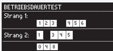
In der folgenden Darstellung werden die Geräte angezeigt, welche sich noch im Betriebsdauertest befinden. Nach 2 Minuten kann der Betriebsdauertest abgebrochen werden.
