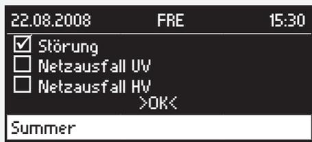
Durch Drehen des Bedienknopfs werden die verschiedenen Zustände angewählt. Die Auswahl eines Zustandes erfolgt durch Drücken des Bedienknopfs. Ein ausgewählter Zustand wird durch einen Haken markiert. Mit „>OK<“ übernehmen Sie die Einstellungen und gelangen wieder ins Menü. Die Zustände sind hierbei „oder“ verknüpft.
