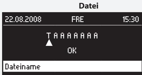
Der Name der Datei besteht aus 8 Buchstaben oder Ziffern. Durch Drehen des Bedienknopfes wird der gewünschte Buchstabe oder die Ziffer ausgewählt. Durch Drücken wird die Eingabe bestätigt und der Cursor wandert zur nächsten Stelle. Nach der Eingabe muss der Name mit einem erneuten Knopfdruck bestätigt werden.
