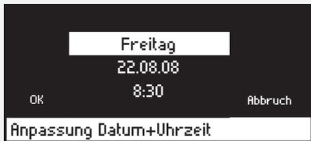
Durch Drehen des Bedienknopfs ist der Wochentag, das Datum sowie die Uhrzeit anzuwählen. Änderungen werden mit Drücken des Bedienknopfs vorgenommen.
