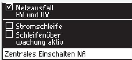
Bei Auswahl der Option „Netzausfall HV und UV“ werden alle entsprechend programmierten Geräte bei Netzausfall Hauptverteiler oder Unterverteiler eingeschaltet, sobald dies von einer CLS gemeldet wird. In diesem Fall werden die Dreiphasenüberwachungen an die Stromschleife der CLS Geräte angeschlossen.
