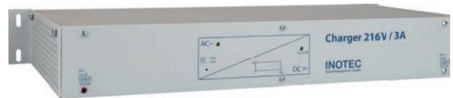
Mikroprozessorgesteuerte, modulare Ladestufe für 230V Zentralbatteriegerät mit max. 7A Ladestrom in 19"-Gehäuse. Ladung erfolgt nach Kennlinie I/U gem. DIN EN 50272-1
