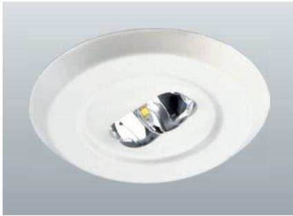
LED-Sicherheitsleuchte mit optimierter Lichtverteilung zur Ausleuchtung von Rettungswegen. Gehäuse aus pulverbeschichtetem Aluminium zum Einbau in Ø 68mm Deckenausschnitt. Inkl. 4-Chip LED-Leuchtmittel für maximale Sicherheit.
