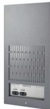
Mikroprozessorgesteuerte, modulare Ladestufe für 230V Zentralbatteriegerät mit max. 3A Ladestrom in 19"-Gehäuse. Ladung erfolgt nach Kennlinie I/U gem. DIN EN 50272-1.
