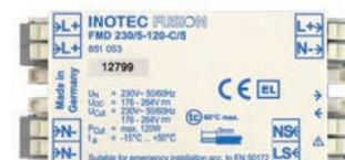
Einzelüberwachungsmodul zum Anschluss an 230V FUSION-Zentralbatterieanlagen zur Überwachung von DALI-Betriebsgeräten mit einer maximalen Last von 120W. Vorgesehen für den Einbau in Leuchten. Adressierung mit fester ID ohne manuelle Adressierung. Permanente Überwachung der Funktion der angeschlossenen DALI-Leuchte durch Kommunikation im DALI-Protokoll.
