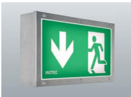
Einseitige Rettungszeichenleuchten aus robustem, gebürstetem Edelstahl mit hoher Schutzart. Homogene Piktogrammausleuchtung durch optimierte LED-Technik mit einer Leuchtdichte  $> 500 \text{ cd/m}^2$ . Zum Einsatz in Lebensmittelbereichen bzw. lebensmittelverarbeitenden Betrieben mit hohen Anforderungen an Produkthygiene geeignet. Optional mit Piktogramm aus Makrolon für erhöhte Schlagfestigkeit IK10+ (50 Joule).
