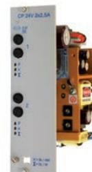
BUS-Unterstation CPUSB mit 2 Stromkreisen zum Anschluss an Zentralbatteriesystem CPS FUSION zur Versorgung, Steuerung und Überwachung von 24V-D.E.R.-Leuchten (FL-Serie). Mischbetrieb innerhalb eines Stromkreises mit 24V INOTEC LED-Systemleuchten.
