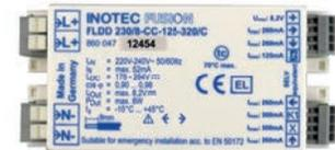
Einzelüberwachungsmodul zum Anschluss an 230V FUSION-Zentralbatterieanlagen zur Überwachung von Leuchten von 5-120W. Vorgesehen für den Einbau in Leuchten. Mit integriertem 230V Schalteingang für geschaltetes Dauerlicht oder für lokale Phasenwächterfunktion der Allgemeinbeleuchtung. Adressierung mit fester ID ohne manuelle Adressierung. Erkennung einer Leuchtenstörung bei min. Stromabweichung von 25% vom Nennstrom.
