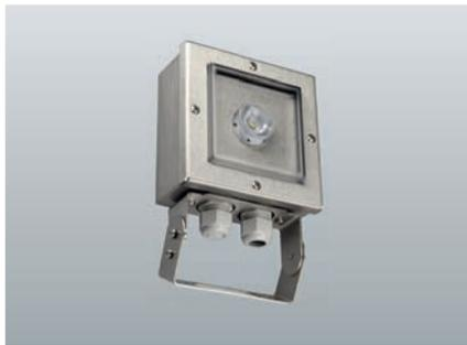
Robuste LED-Sicherheitsleuchte mit optimierter Lichtverteilung zur Ausleuchtung von Flächen mit großen Lichtpunkthöhen bis zu 24m. Leuchte aus gebürstetem Edelstahl mit hoher Schutzart. Zum Einsatz in Lebensmittelbereichen bzw. lebensmittelverarbeitenden Betrieben mit hohen Anforderungen an Produkthygiene geeignet. Arretierbarer Befestigungsbügel zur Ausrichtung der Leuchten auf den zu beleuchtenden Bereich.
