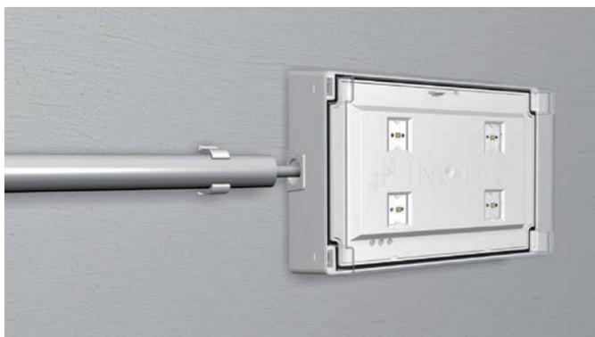
Bei Aufputzinstallationen können vorgeprägte, seitliche Öffnungen einfach ausgebrochen werden. Eine Kabeldurchführungsstülpe ermöglicht die saubere Einführung der Leitung. Der gekapselte Anschlussbereich im Inneren der Leuchte gewährleistet weiterhin die hohe Schutzart IP65. Die Prägungen sind auf drei Seiten der Leuchte in doppelter Ausführung eingebracht, so dass auch eine Durchgangsverdrahtung möglich ist.
