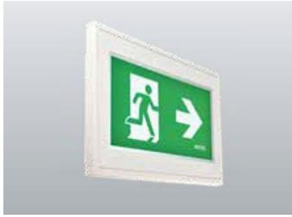
Multifunktionale dynamische TFT-Piktogrammleuchte aus Stahlblech pulverbeschichtet. Zur richtungsvariablen Anzeige des sicheren Fluchtweges und Sperrung betroffener Bereiche in Abhängigkeit der Rauchausbreitung eines Brandes sowie Anzeige diverser Sicherheitszeichen oder kundenspezifischer Piktogramme. Durch das eingesetzte TFT, inkl. Backlight- und Bildinhaltüberwachung werden die Piktogramme normkonform angezeigt und können einfach ausgetauscht werden.
