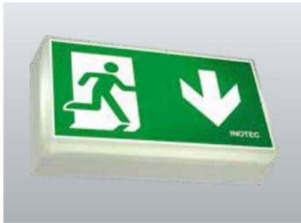
Einseitige Rettungszeichenleuchten aus UV- und glühdrahtbeständigem Polycarbonat mit optionaler seitlicher Kabeleinführung und großzügigem rückseitigen Rangiererraum. Homogene Piktogrammausleuchtung durch optimierte LED-Technik.
