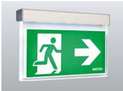
Rettingszeichen-Scheibenleuchten mit rahmenloser, freihängender 20mm Acrylglascheibe aus hochwertigem eloxiertem Aluminiumprofil ohne sichtbare Schrauben. Homogene Piktogrammausleuchtung durch optimierte LED-Technik. Dezent es Gehäuse dank 24V-Technik.
