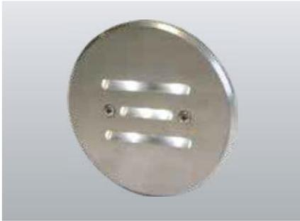
Runde LED-Sicherheitsleuchten zur Ausleuchtung von Stufen oder Rettungswegen. Leuchten für Wand- und Stufeneinbaumontage. Ausführung mit gebürsteter Edelstahlblende zum Einbau in Schalterdose Ø 68mm.
