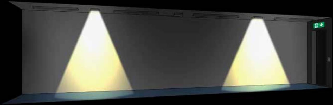
Aber auch wenn mehrere LEDs in einer Sicherheitsleuchte eingesetzt werden, so kann der Ausfall einer LED dazu führen, dass das nach DIN EN 1838 geforderte Beleuchtungsniveau von 1lx auf dem Rettungsweg nicht mehr erreicht wird.
