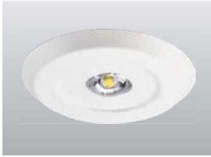
LED-Sicherheitsleuchte mit optimierter Lichtverteilung zur Ausleuchtung von kleinen Flächen wie WCs oder elektrische Betriebsräume mit einer Leuchte. Leuchten für Deckeneinbaumontage mit pulverbeschichteter Aluminiumblende ohne sichtbare Schrauben. Zum Einbau in Ø 68mm Schaltdose. Inkl. 4-Chip LED-Leuchtmittel für maximale Sicherheit.
