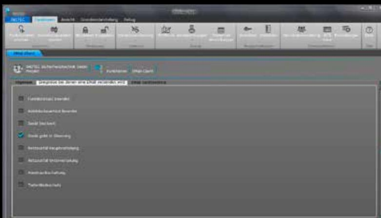
Es kann genau definiert werden nach welchem Ereignis für ein Gerät eine Benachrichtigung per E-Mail versendet wird. Alternativ kann auch täglich eine Mail zu einer angegebenen Uhrzeit über alle Geräte mit einem auffälligen Status versendet werden.
