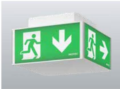
Vierseitige Rettungszeichenleuchte mit eloxiertem Aluminium-Eckprofil und vielseitig einsetzbarem Anschlusskasten aus weißem UV- und glühdrahtbeständigem Polycarbonat mit optionaler seitlicher Kabelführung. Homogene Piktogrammausleuchtung durch optimierte LED-Technik mit einer Leuchtdichte > 500 cd/m<sup>2</sup> und je Leuchtenseite einzeln auswechselbaren Piktogrammen.
