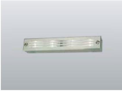
Die Sicherheitsleuchte SN 6203.1 besteht aus hochwertigem Aluminium und gebürstetem Edelstahl. Die Leuchte eignet sich zur Montage an Stufen oder Wänden. Die Leuchte ist je nach Anwendungsgebiet mit opaler Scheibe oder Gitterblende erhältlich. IP65 Leuchtenausführung inkl. 1 x 10m Anschlussleitung H05RN-F 2 x 0,75 mm<sup>2</sup>.
