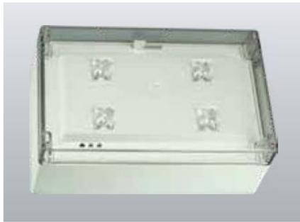
Universelle LED-Sicherheitsleuchten zur flächigen Ausleuchtung von Rettungswegen mit einer Breite von 3-4m und einer Lichtpunkthöhen bis zu 18m. Leuchten für Deckenmontage aus UV- und glühdrahtbeständigem Polycarbonat. Mit optionaler seitlicher Kabeleinführung und großzügigem rückseitigen Rangierraum.
