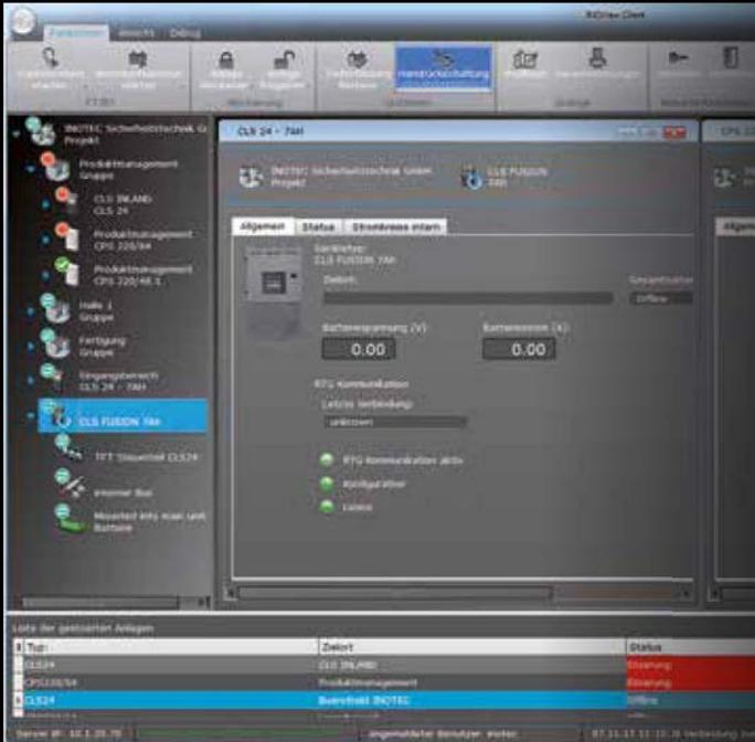
INOView ist die zentrale Überwachungslösung für alle INOTEC Notlichtsysteme. Diese Software wird überall dort eingesetzt, wo eine flexible Anwendung gefordert ist, die mit dem Projekt skaliert. Die Geräte können dabei entweder per dreidrigem RTG-Bus und/oder Netzwerkanbindung überwacht werden.
